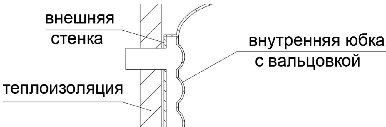
2.1. Бойлер FB INOX сконструирован по схеме внутренний бак бойлера (контур горячего водяного снабжения (далее ГВС) с водяной юбкой (контур обогрева бойлера через систему отопления (далее СО). Для повышения производительности внутри водяной юбки предусмотрены направляющие потока воды. Для увеличения прочности, внутренние стенки имеют вальцовку.
